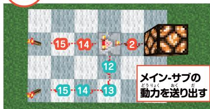
(メイン)-サブの動力のみ送り出す減算モード。サブ入力の動力がメインを上回ると回路が切れる。
