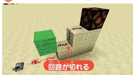
階段状の回路で角を塞ぐようにブロックを置くと、回路が途中で切斷されてしまうので注意。ただし、同じ位置にガラスを置くと、回路は切れず動力も通過することができる。
