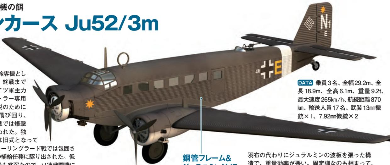
**DATA** 乗員3名、全幅29.2m、全長18.9m、全高6.1m、重量9.2t、最大速度265km/h、航続距離870km、輸送人員17名、武装13mm機銃×1、7.92mm機銃×2
