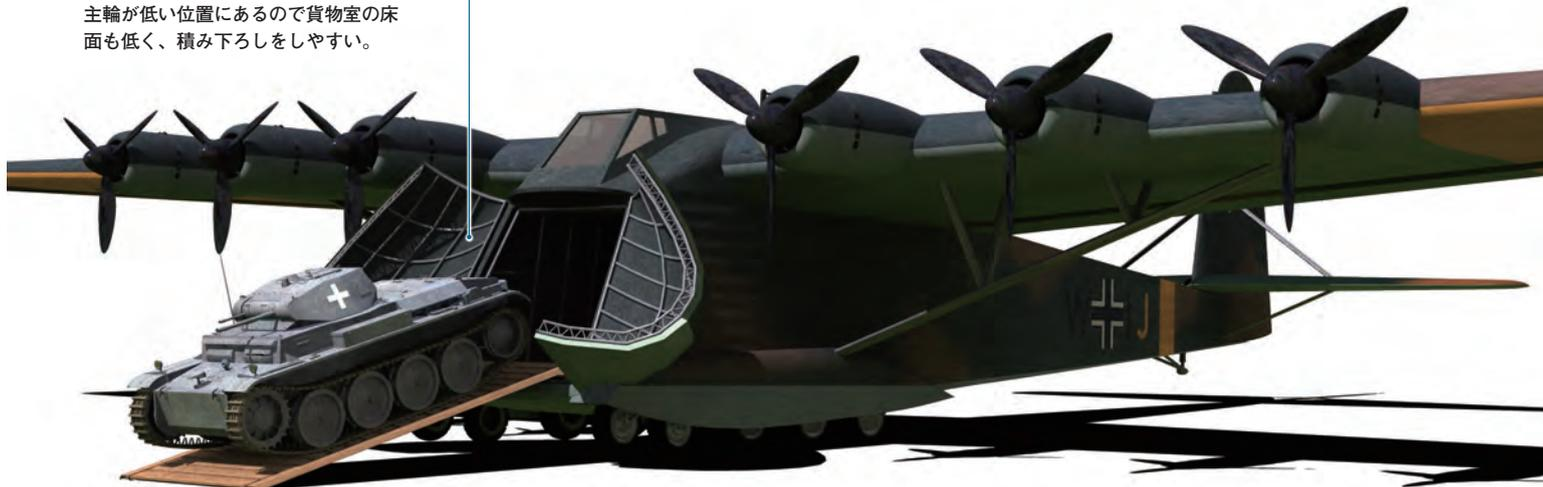
もともとは大型の輸送グライダーだったが、巨大すぎて曳航が難しかったため、占領下フランスで入手し易かったノーム・ローンエンジンを6発装備して輸送機となった。機体は羽布張りという前時代的な構造であるが、前部を開閉式扉にして荷物を積載できるなど発想は先進的で、後の大型輸送機に影響を与えた。198機が生産されている。
